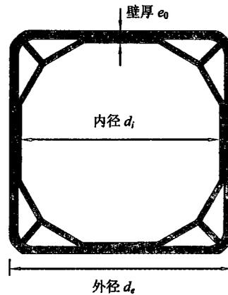
图1 典型的塑料合金管断面结构示意图
